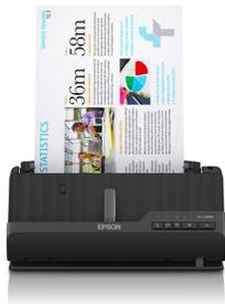
La posizione del percorso a U dello scanner consente la scansione della carta senza aumentare l'ingombro del dispositivo. Per scansionare passaporti e libretti fino a 5 mm di spessore, è possibile passare alla modalità di percorso rettilineo. La tecnologia di protezione della carta garantisce che i documenti originali rimangano intatti. Realizzato con fino al 30% di plastica riciclata e con un basso consumo energetico, ha anche un minore impatto ambientale.
